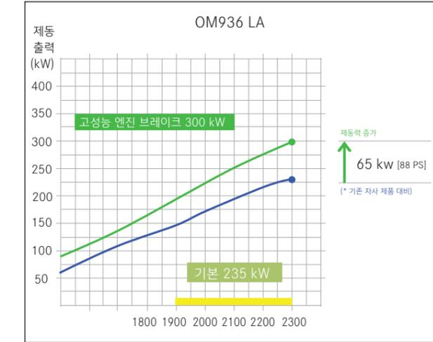
고성능 엔진 브레이크(HPB) 및 작동 레버 (변속 레버 겸용) | 총 제동력을 약 408마력으로 크게 높여 줍니다.
